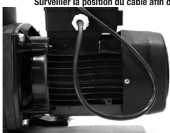
Correct! Evite l'entrée de l'eau par le câble électrique.
