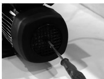
С целью предотвращений блокировки механического запора, перед запуском или после продолжительное неизпользование насоса повернуть ось через вентиляторию.
