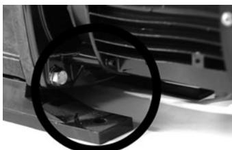
Contrôler régulièrement l'étanchéité! (Une fuite au niveau de la garniture mécanique peut provoquer des dommages importants!)
